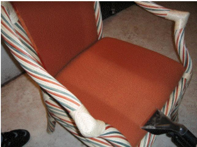
Jetzt wird mit dem speziell von und entwickelten Reinigungsgerät Wasser auf den Stoff gesprüht und sofort wieder abgesaugt. Unsere Maschine hat extra eine so hohe Saugleistung bekommen, um in einem Arbeitsgang 99% des Wassers wieder aufzunehmen. Der Vorteil dabei ist eine schnelle Nutzung ohne lange Wartezeit. Die Stühle wurden nach dem absaugen mit unserem Hochleistungsgebläse getrocknet. Die Trocknungszeit war ca. 15 Minuten.
